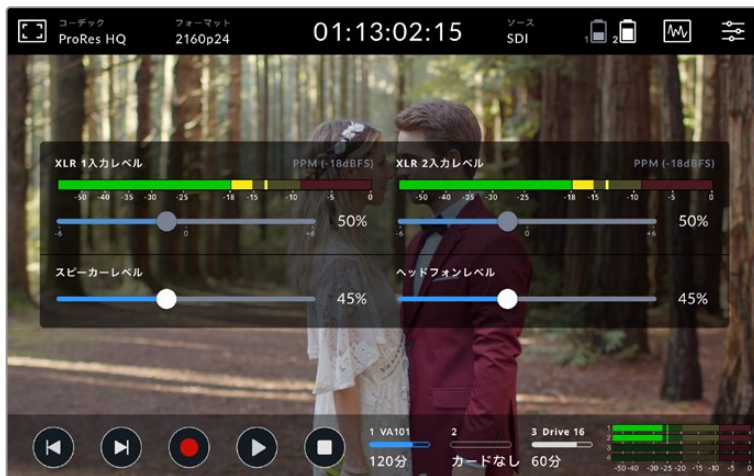
7インチモデルのVideo AssistではXLRオーディオレベルを調整可能
