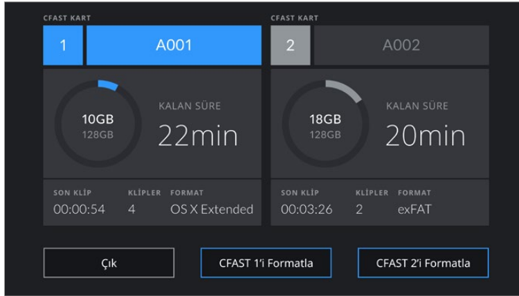
Depolama yöneticisine girmek için, URSA Broadcast'ın dokunmatik LCD ekrandaki depolama göstergelerini tıklayın.
