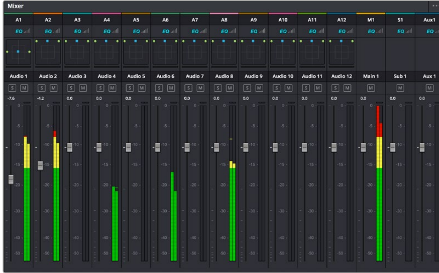
Timeline'deki ses kanalları ile eşleşen kanal şeritleri ile ses mikseri
