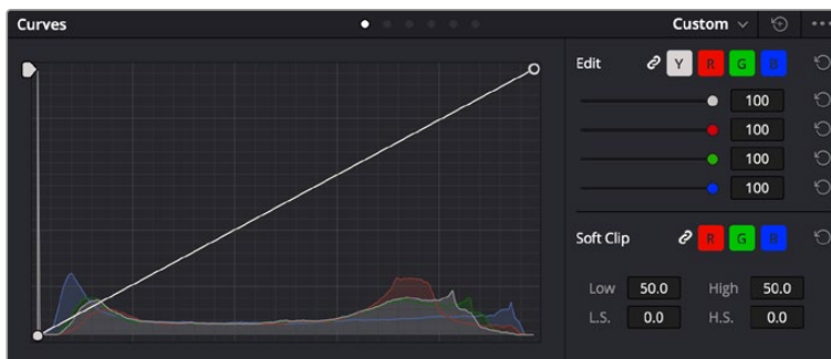
La finestra delle curve è un ulteriore strumento destinato alla correzione primaria e alla valorizzazione di aree specifiche quando si usa una Power Window
