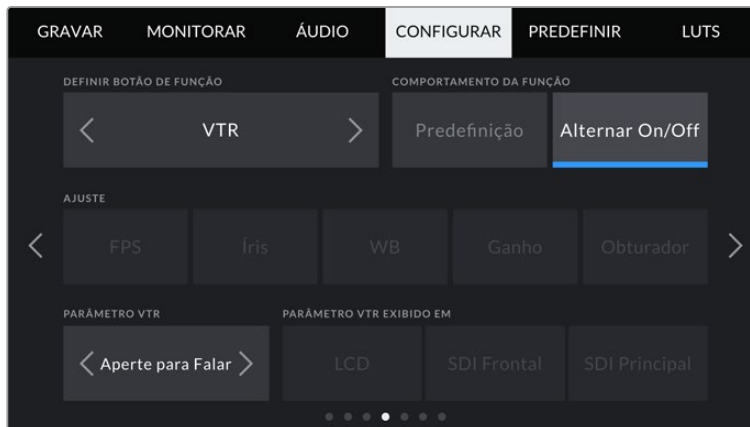
Configuração de um botão “VTR” em uma lente B4 para funcionar como um botão “Aperte para Falar”.
