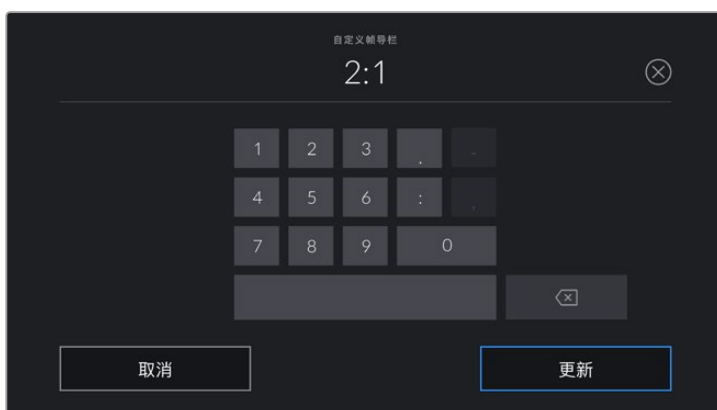
使用“CUSTOM FRAMEGUIDE” (自定义帧导栏) 屏幕上的数字键盘输入一个新的帧导栏比例
