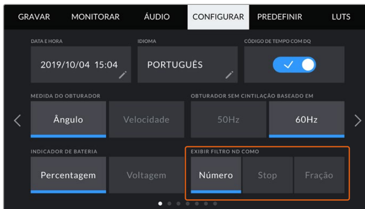
Menu de configuração da URSA Broadcast com a opção de customizar como as informações do filtro ND são exibidas.
