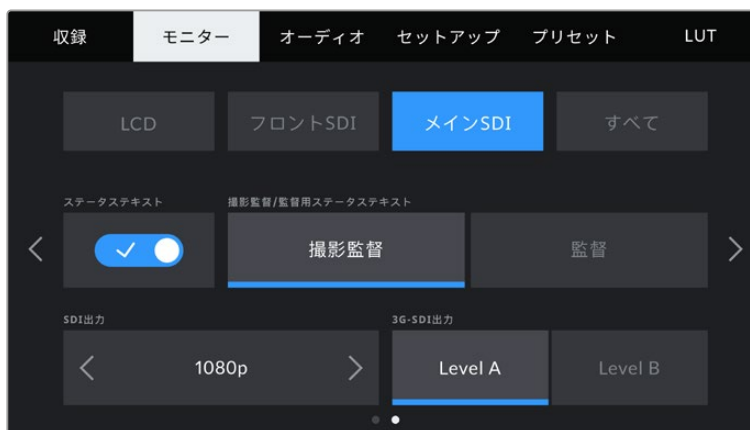
「A」または「B」をタップして、3G-SDI出力のLevel AとLevel Bを切り替え
