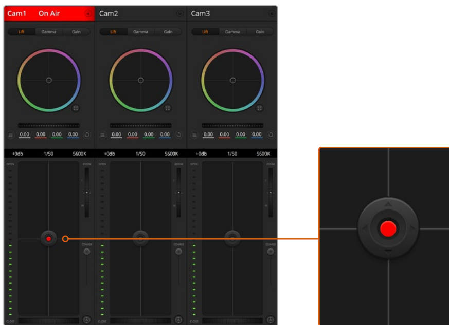
El control del diafragma/pedestal se enciende de color rojo cuando la cámara está al aire
